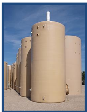
TANQUE DE LAVADO
